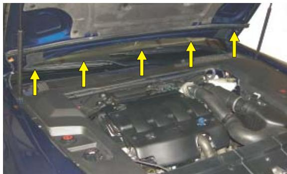
PL Ostrożnie wypiąć maskownicę podszybia zwracając uwagę na wążek spryskiwacza
